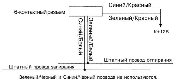
Схема 2. 3-проводная система с положительной полярностью (большинство автомобилей GM)
