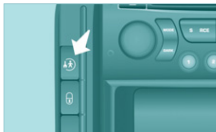
Электрическая блокировка дверных замков
