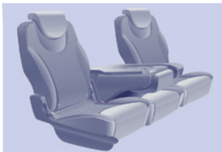
Тип 3: двухместное сиденье с отдельными спинками, складывающимися в положение "стол" и поднимающейся подушкой.
