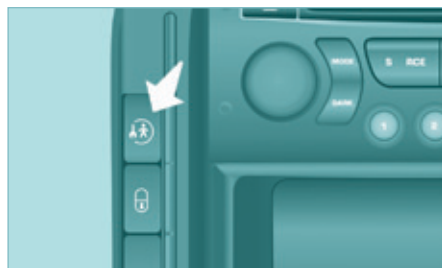
Электрическая блокировка дверных замков
