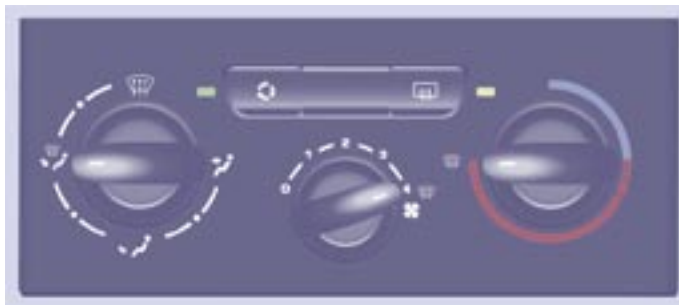
Панель управления отоплением
