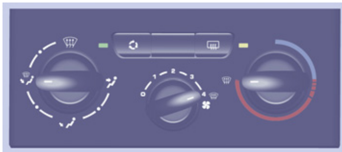
Панель управления отоплением
