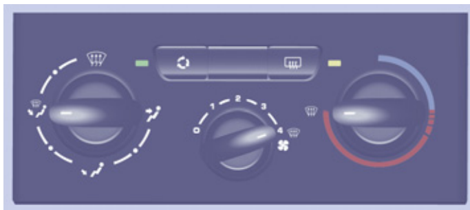
Панель управления отоплением
