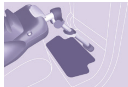
Установка стойки рядом с крышкой ящика
