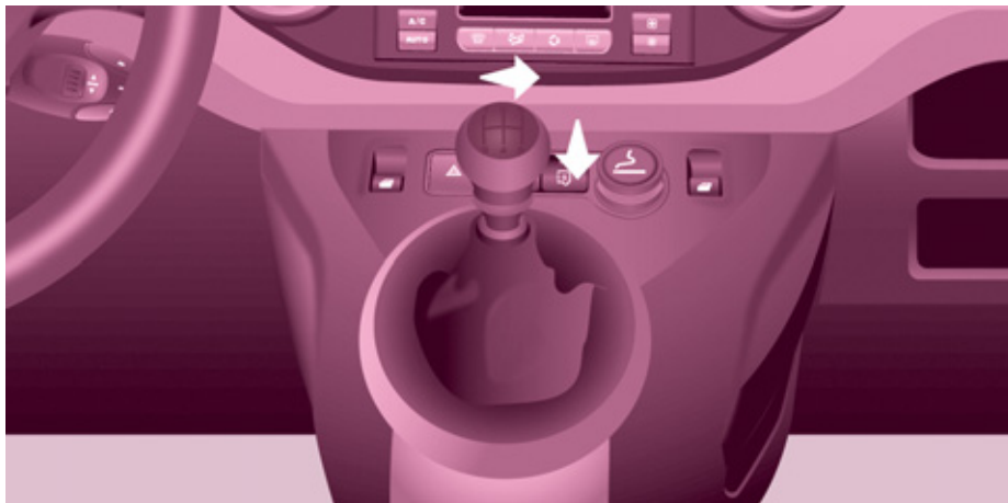
5-ступенчатая коробка - передача заднего хода
