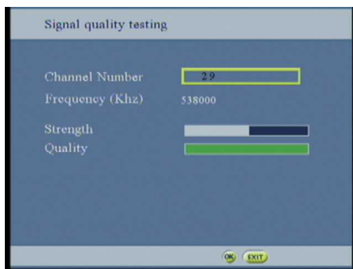
Илл.10: Экран регулировки антенны
