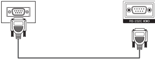
Последовательный управляющий кабель RS-232C (перекрестного типа)
