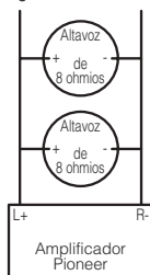
Modo de conexión en puente de 4 ohmios
