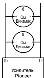
Мостовое соединение 4 Ом
