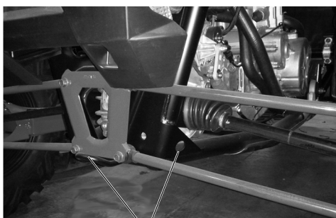
2 задние точки крепления при транспортировке (или буксировочная петля)
