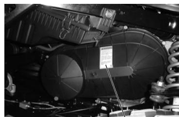
Предупреждение на крышке вариатора
