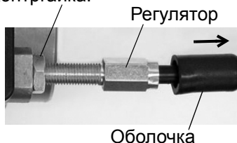
Регулировка тросика Контргайка.
