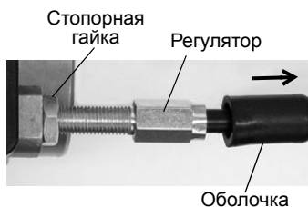
Регулировка тросика привода акселератора
