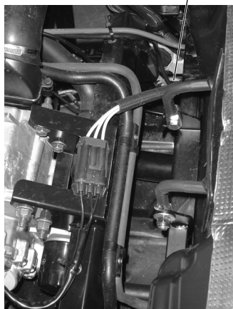
Блок силового предохранителя
