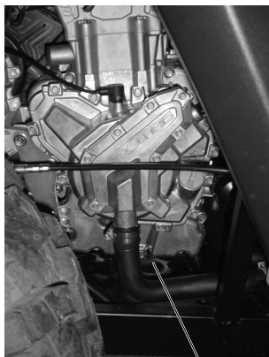
Расположение сливной пробки
