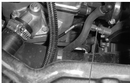
Регулировка тросика привода акселератора
