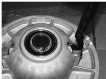
Вставьте загнутую часть инструмента внутрь.
