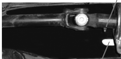
Доступ к штуцеру (вид сверху при снятой центральной панели)
