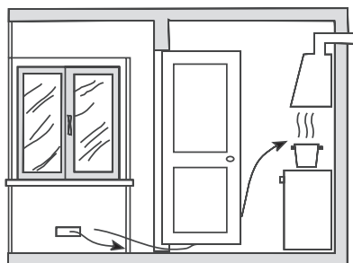
Мал. 3. Забезпечення необхідного зазору між дверима приміщення та порогом для вільного проходження приливної повітря
