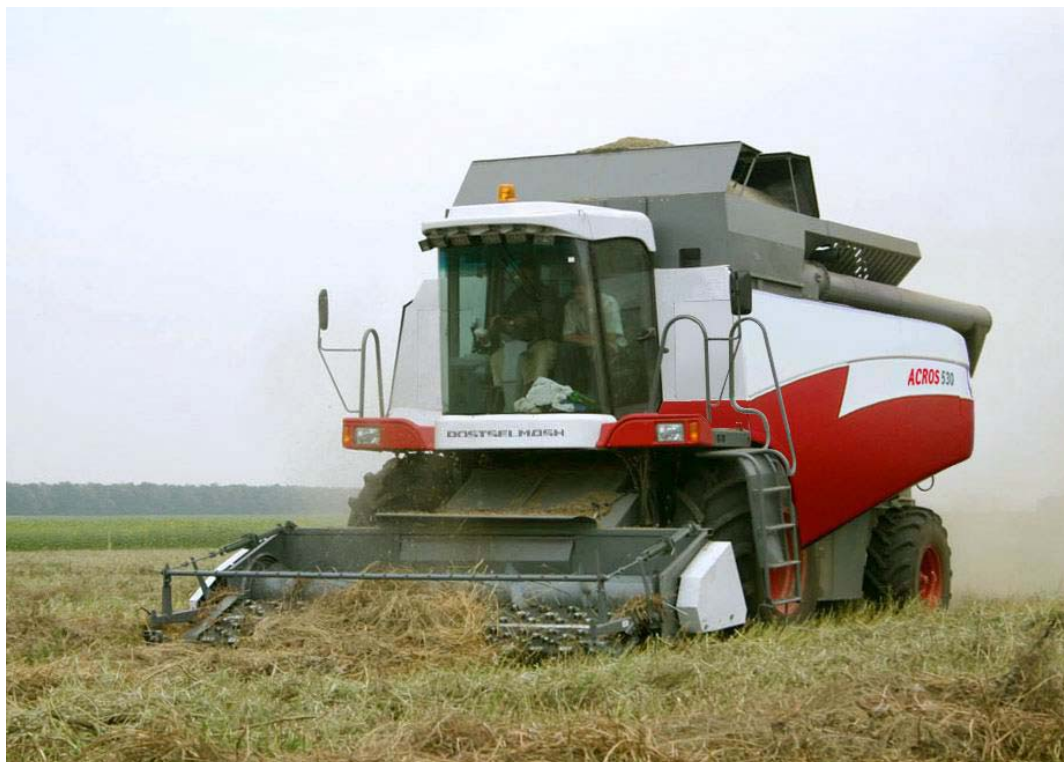
Рисунок 2.6 - Технологический процесс подбора валков платформой-подборщиком
