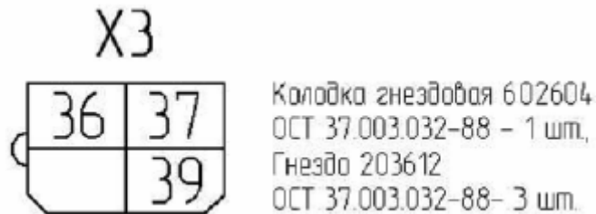
Рисунок 6.51- Разъем X3: колодка подключения к акустической системе комбайна.
