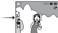
2. Нажмите кнопку спуска до половины хода, чтобы навести резкость на объект съемки.
