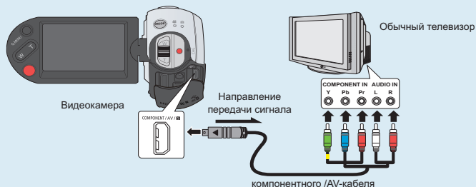
Тип А: Подключение компонентного/AV-кабеля к компонентному выходу.
