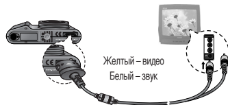
[Подключение аудио- и видеокабеля к фотокамере]
