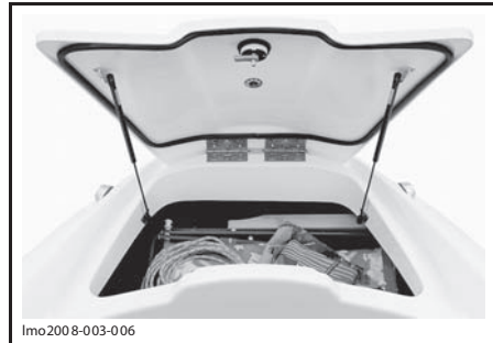
ТИПОВОЙ ВАРИАНТ — НОСОВОЕ БАГАЖНОЕ ОТДЕЛЕНИЕ
