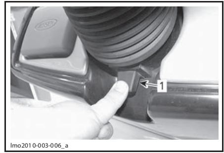
ИМО201 0-003-006_a ЧТОБЫ ВЫПОЛНИТЬ РЕГУЛИРОВКУ ПОЛОЖЕНИЯ ШТУРВАЛА, НАЖМИТЕ И УДЕРЖИВАЙТЕ КНОПКУ В НАЖАТОМ ПОЛОЖЕНИИ 1. Кнопка
