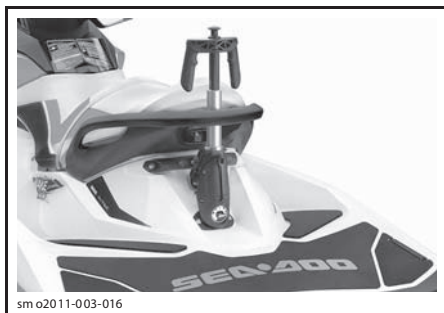
ТИПОВОЙ ВАРИАНТ — ПИЛОН ФАЛА ВОДНО-ЛЫЖНИКА/ВЕЙКБОРДИСТА ПОДНЯТ Чтобы сложить пилон, нажмите на его верхнюю часть.
