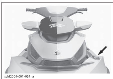
ТИПОВОЙ ВАРИАНТ — РАСПОЛОЖЕНИЕ КРЫШКИ ТОПЛИВОЗАПРАВОЧНОЙ ГОРЛОВИНЫ
