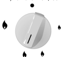
Внешний контур на минимальной мощности, внутренний – на максимальной.
