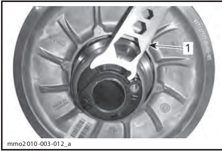
ПЛАСТМАССОВАЯ РЕГУЛИРОВОЧНАЯ МУФТА 1. Приспособление для регулировки
