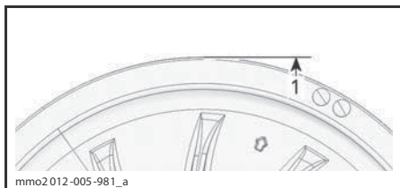
1. Приводной ремень вровень с краем ведомого шкива
