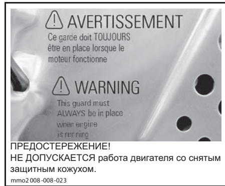
ТАБЛИЧКА 17 — НА КОЖУХЕ ТОРМОЗНОГО ДИСКА (МЕТАЛЛИЧЕСКИЙ ТОННЕЛЬ)
