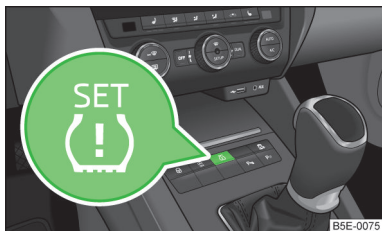
Илл. 191 Клавиша установки контрольных значений давления в шинах
