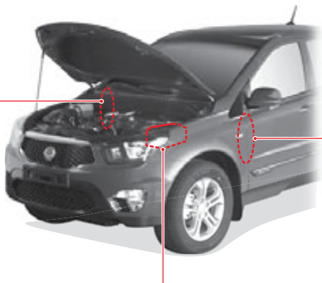
Блок предохранителей в моторном отсеке
