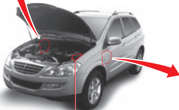
Блок предохранителей в моторном отсеке
