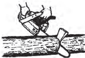
выключите пилу и используйте пластиковый или деревянный клин, чтобы расширить пропил
