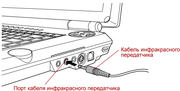
Подключение кабеля инфракрасного передатчика
