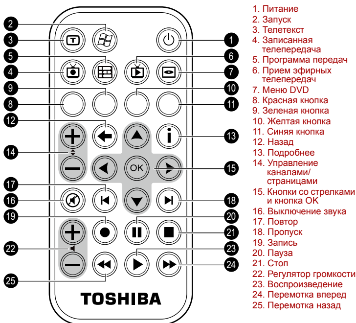
Рисунок 2-10 Пульт дистанционного управления типа 2
