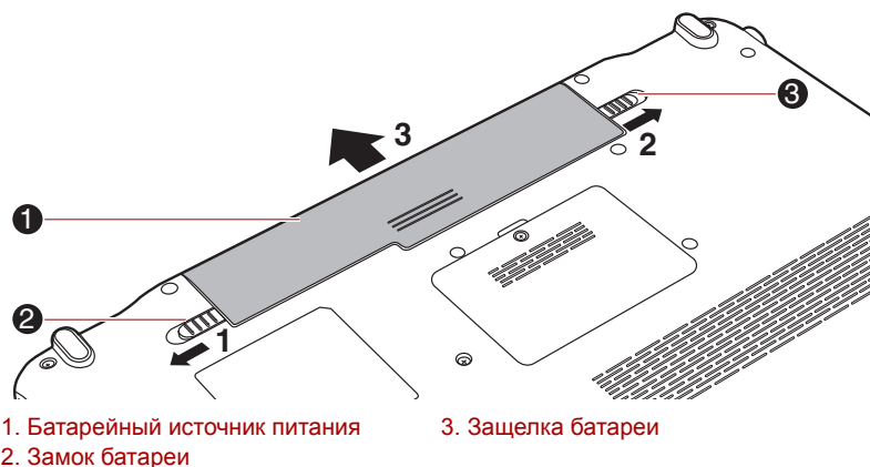
Рисунок 6-1 Высвобождение батарейного источника питания
