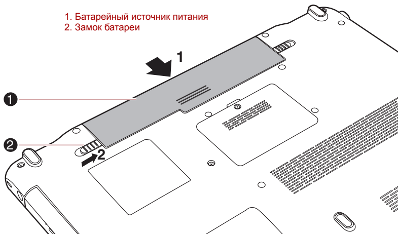
Рисунок 6-2 Закрепление батарейного источника питания
