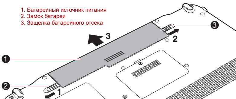
Рисунок 6-1 Высвобождение батарейного источника питания
