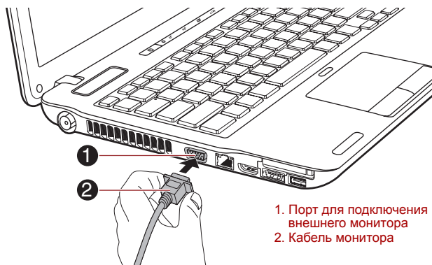
Рисунок 3-10 Подсоединение кабеля монитора к гнезду для внешнего монитора.
