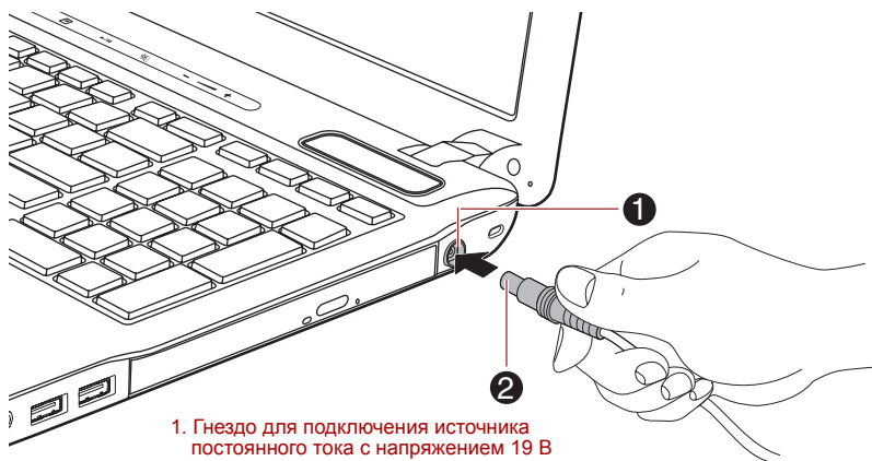
Рисунок 1-3 Подключение штекера вывода адаптера переменного тока к компьютеру
