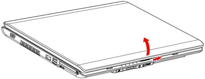
Рисунок 3-3 Открываем панель дисплея
