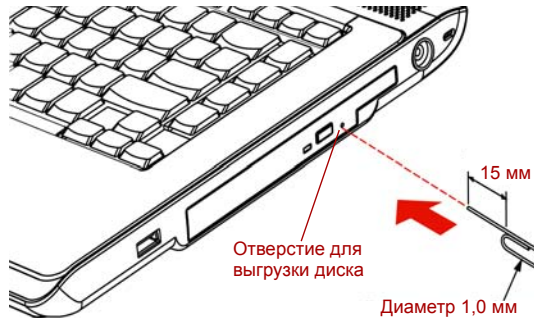
Рисунок 4-2 Открываем лоток вручную через отверстие для выгрузки диска
