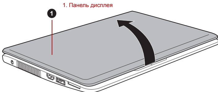
Рисунок 1-4 Открытие панели дисплея (T210)
