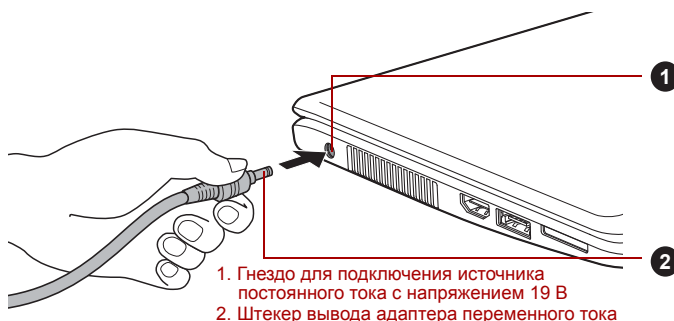
Рисунок 1-3 Подключение штекера вывода адаптера переменного тока к компьютеру (T210)
