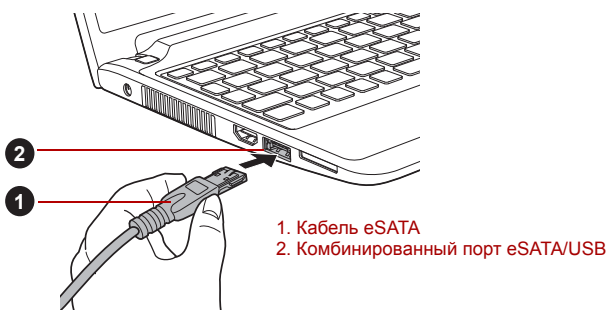
Рисунок 3-13 Подключение кабеля eSATA к комбинированному порту eSATA/USB (T210)
