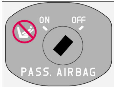
Переключатель SRS в положении OFF (Выкл).
