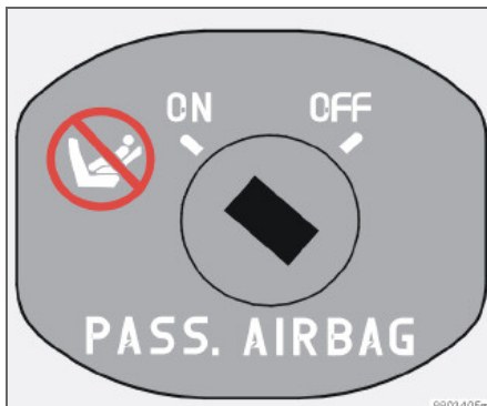
Переключатель SRS в положении ON (Вкл).
