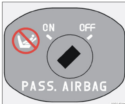
Переключатель SRS в положении OFF (Выкл).
