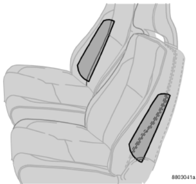
Расположение боковых подушек безопасности.
