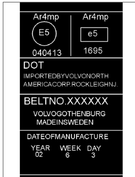
Маркировка ремней безопасности с натяжителем.
