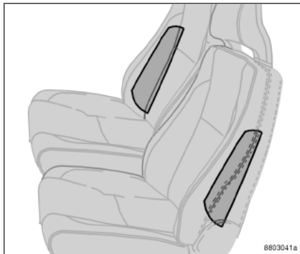
Расположение боковых подушек безопасности.
