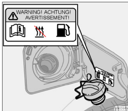
Предупреждающая табличка на крышке топливного бака.
