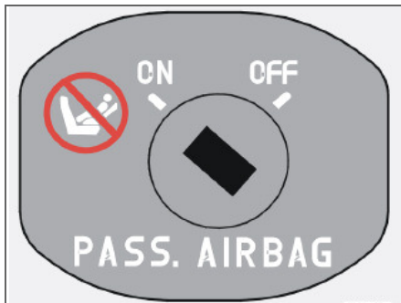
Переключатель SRS в положении ON (Вкл).
