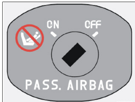
Переключатель SRS в положении OFF (Выкл).
