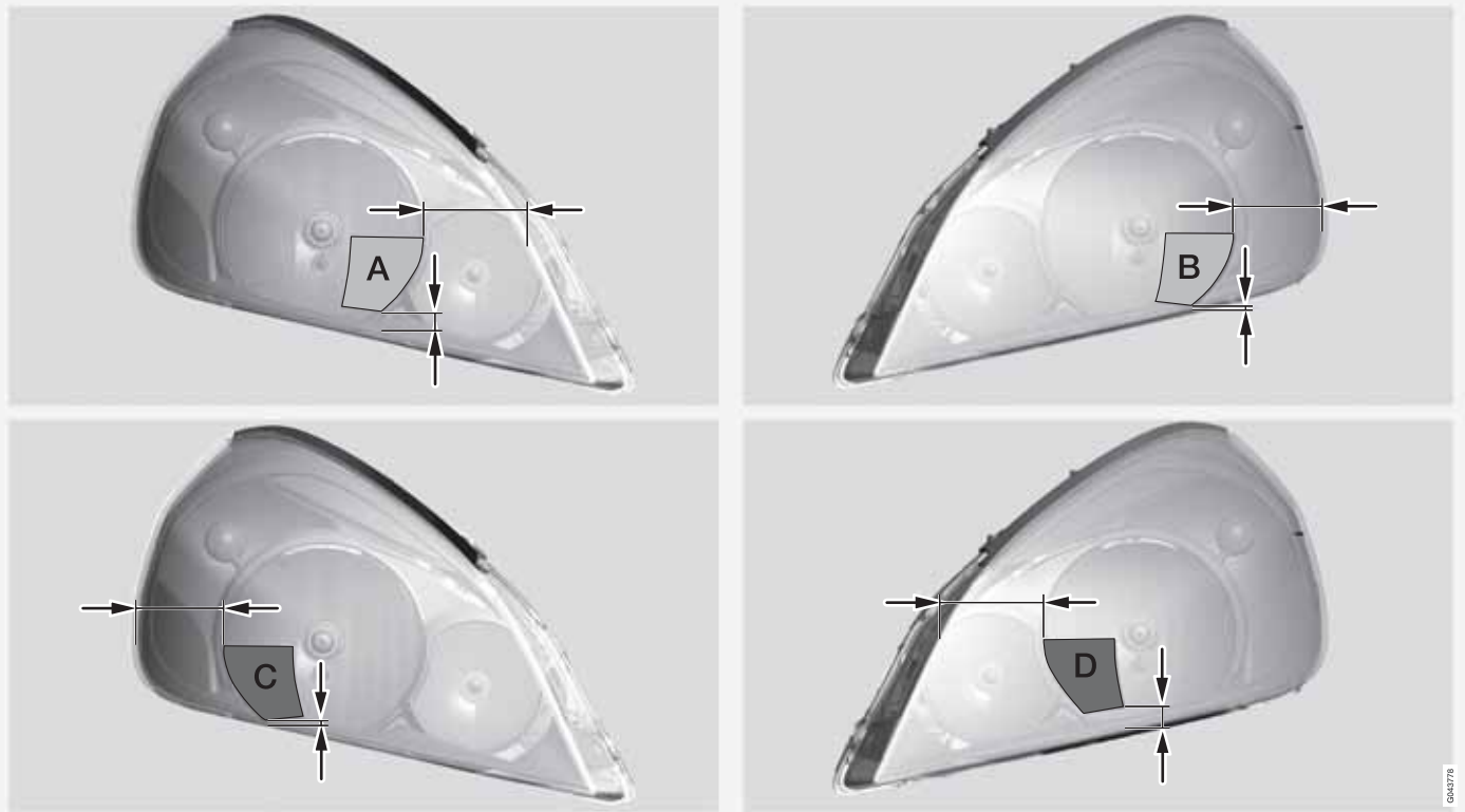
Верхний ряд: маскировка автомобиля с левосторонним управлением, шаблоны А и В. Нижний ряд: маскировка автомобиля с правосторонним управ-
