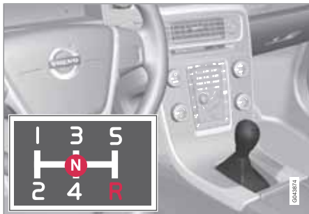
Схема переключения передач, 5-ступенчатая коробка передач
