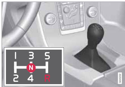
Схема переключения передач, 5-ступенчатая коробка передач.
