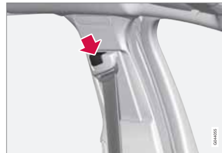
Регулировка ремня безопасности по высоте. Нажмите кнопку и переместите ремень безо-
