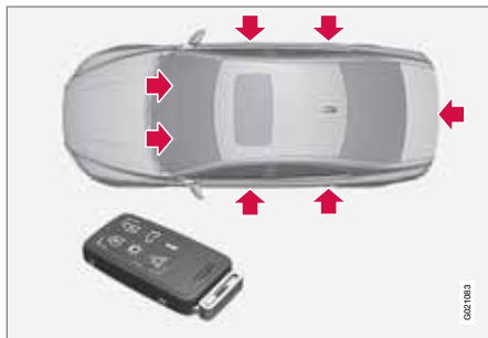
Точки запирания дистанционным ключом с плоским ключом.
