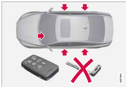
Точки запирания дистанционным ключом без плоского ключа, когда скрытое запирание активировано.
