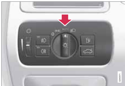
Ручка регулировки света в положении AUTO .
