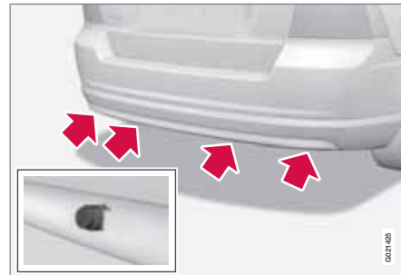
Расположение задних датчиков.
