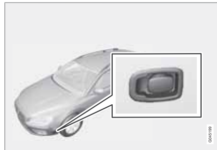
Гнездо для подключения подогревателя двигателя.
