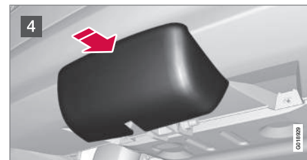
4 Задвинув, зафиксируйте защитную крышку.
