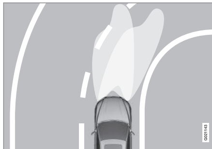
Форма светового пятна с отключенной функцией (слева) и активированной функцией (справа).
