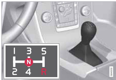
Схема переключения передач, 5-ступенчатая коробка передач.
